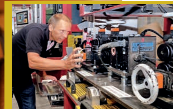
FEHLER ERKANNT: Christoph Schulte an der Anlage, die mit Wirbelstrom den Draht prüft und Fehler markiert.
